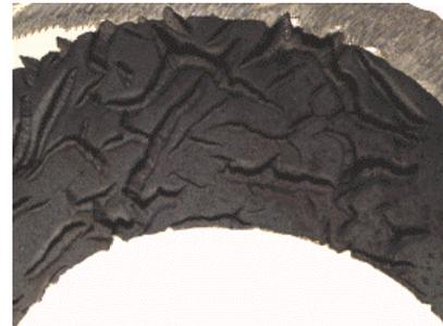
**Décarburation par l'hydrogène**
